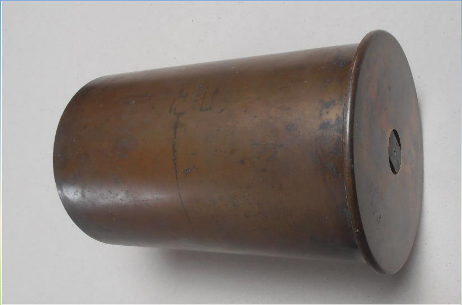
Messing Kartusche s.F.H. 18. uit 1936, hergebruikt met ijzer slaghoedje 1943.
