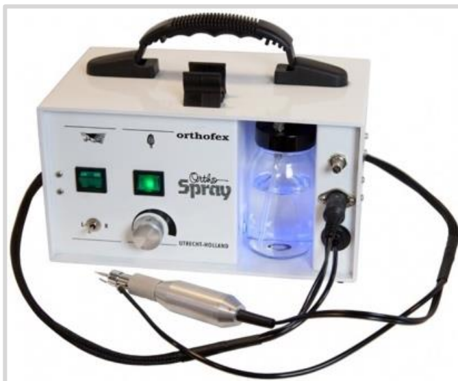
Afbeelding 32: Freesapparaat met zichtbaar vloeistofreservoir dat verbonden is met het handstuk door een aparte buis. (Orthofex spray, 2016)
